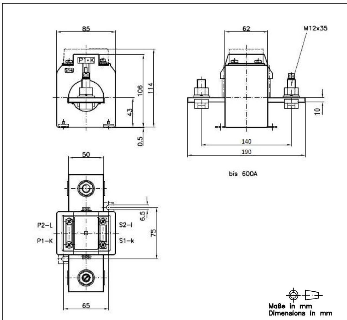
Abbildung 8 - Stromwandler
