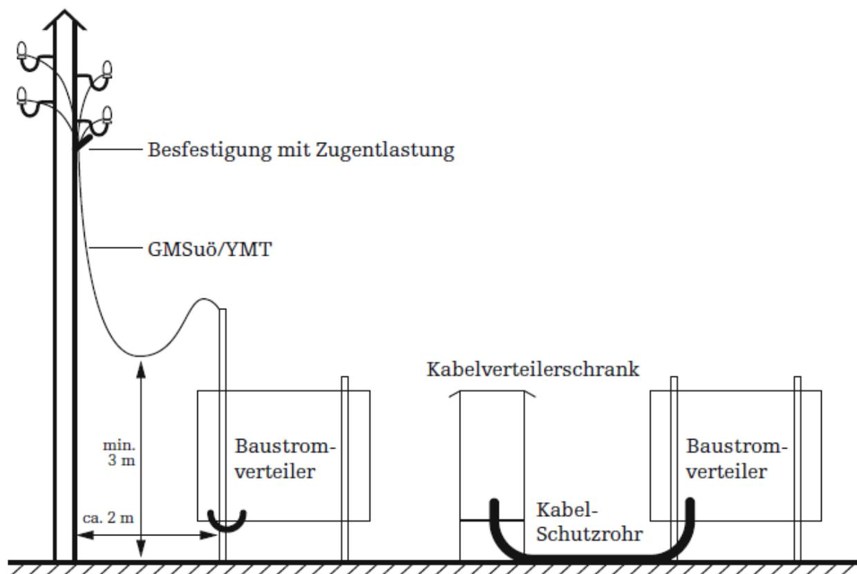
Abbildung 11: Prinzip-Anordnung für den Anschluss eines Baustromverteilers
